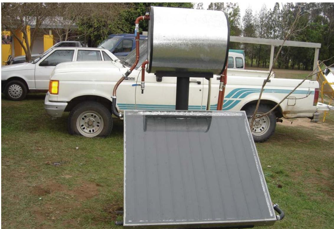
Una vez identificado el consumo diario de agua caliente, deberá tenerse en cuenta que cada módulo de captador solar es de  $1 \text{ m}^2$  de área efectiva y es para un termo de 80 litros de agua a  $45^\circ \text{C}$ . La cantidad de captadores y capacidad del termotanque debe corresponder al consumo diario de agua caliente.
