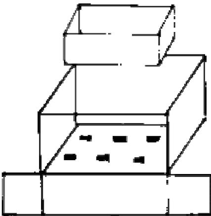
9. Colocar el aislamiento entre ambas cajas; el material de aislamiento debe estar siempre seco, no debe derretirse ni producir vapores a temperaturas elevadas. Se recomienda los siguientes materiales: plumas, lana, cartones del tamaño de las paredes de la caja exterior cubiertos con papel de aluminio, bolitas de papel de diario arrugado del tamaño de un pequeño limón, fibras secas de plantas, cáscara de arroz, paja, hojas secas del banano.
