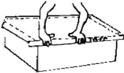
13. Hacer la ventana y el reflector: Dibuje un rectángulo en el interior de la tapa, que sea del tamaño de la caja interior pero un poquito más pequeño que el vidrio que piensa ponerle. Corte solo tres lados, uno largo y dos cortos y deje el largo para doblarlo y usarlo como reflector. El hueco en la tapa será el marco de la ventana.
