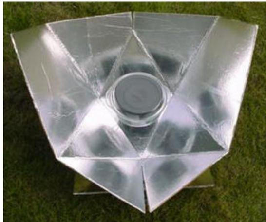
Para cocinar, primero colocamos la cocina según la altitud del sol y la enfrentamos hacia este. Luego colocamos los alimentos en un recipiente de metal negro, y a su vez, metemos éste en una bolsa para horno o en un recipiente de vidrio con tapa.
