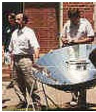
La cocina parabólica SK2 que tiene el foco profundo por seguridad.
